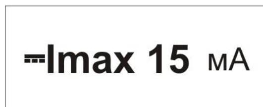
Рис.6 Установка значения тока отсечки
